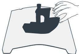
1. A. Lorsque l'impression est terminée, attendre que la plaque de la plate-forme refroidisse avant de retirer la plate-forme d'impression avec le modèle attaché; B. Pliez légèrement la plate-forme avec les deux mains pour séparer le modèle de la plate-forme.
