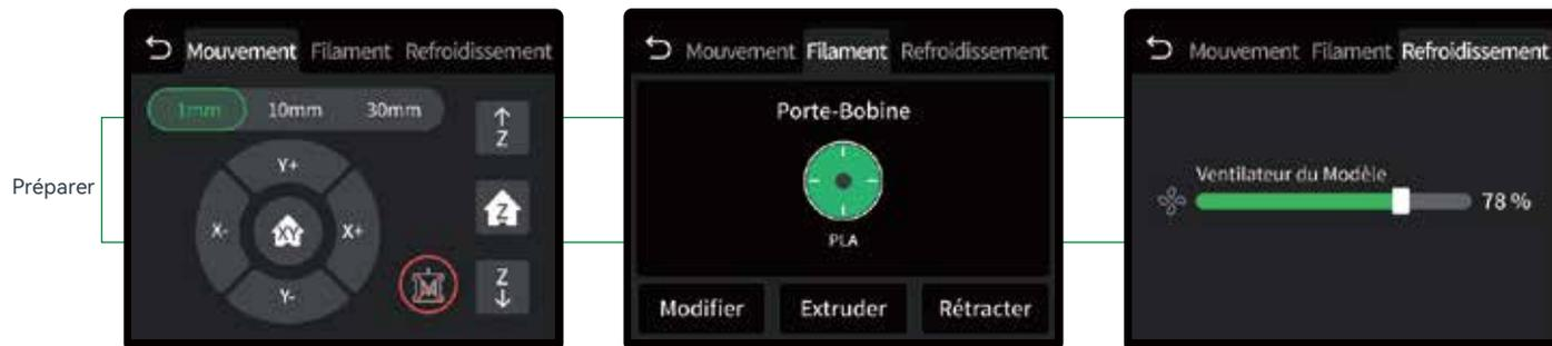
\*Les fonctions telles que le mouvement des axes, l'édition/extrusion/rétraction du filament, le refroidissement, etc., peuvent être définies via l'interface de préparation.
