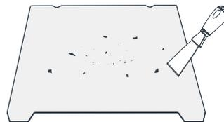
2. Se houver filamentos residuais sobre a placa da plataforma, raspe-os levemente com uma lâmina e imprima novamente.
