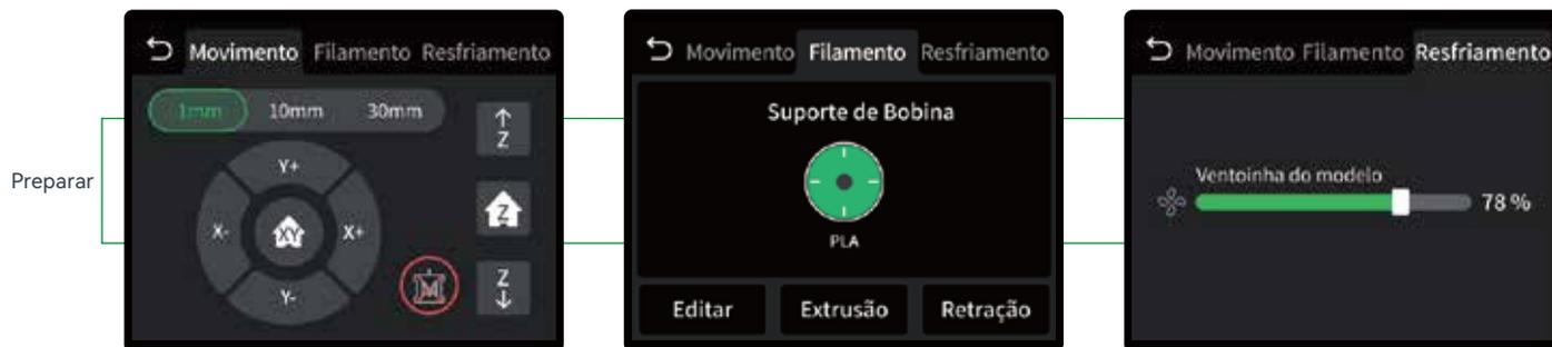
\*Funções como movimentação dos eixos, edição/extrusão/retração do filamento, resfriamento, etc., podem ser definidas através da interface de preparação.
