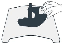
1. Quando a impressão estiver concluída, aguarde que a placa da plataforma esfrie antes de remover a placa de impressão com o modelo anexado; B. Dobre levemente a plataforma com ambas as mãos para separar o modelo da plataforma.
