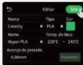
Clique em "Filamento" → "Editar", depois configure a marca, tipo, nome e cor do filamento, e finalmente clique em OK para salvar as configurações; (Consumíveis RFID não requerem edição)
