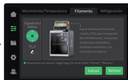
4 Si los filamentos no son compatibles con el reconocimiento RFID, debes hacer clic manualmente en la pantalla para configurar la información del filamento: Página de ajuste → Filamentos → Editar (como se muestra debajo del estante de materiales), configura la marca-tipo-nombre-color del filamento respectivamente, y finalmente haz clic en OK para guardar la configuración.
