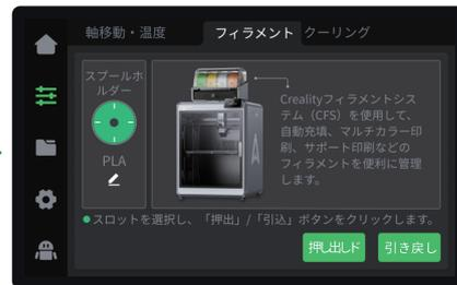
④ フィラメントがRFID認識に対応していない場合、手動で画面をクリックしてフィラメント情報を設定する必要があります。調整ページ→フィラメント→編集 (素材ラック下記の表示を参照)、各項目を設定します：フィラメントのブランド・種類・名称・カラーをそれぞれ設定し、最後に[OK]をクリックして設定を保存してください；
