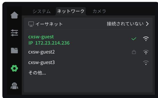
① 機器のスクリーンで機器のIPを確認: "設定" → "ネットワーク";
